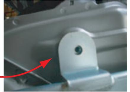
③.ドアヒンジ上下2箇所でガッチリサポートを仮止めします。
