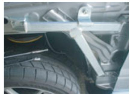
⑦.付属のステー(長)を純正穴から通し、⑥であけた穴を利用してガッチリサポート先端部をボルトで固定します。
